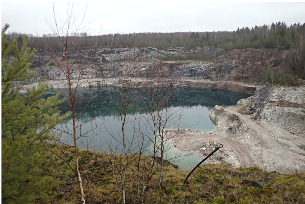
Avolouhosaluetta. Louhosmontun vesipinta noin merenpinnan tasossa ja vesisyvyys noin 40 m. Kuvasuunta pohjoiseen kohti yhtiön suunnittelemaa louhoksen laajennusta.
